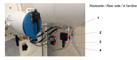
Merkmal Beschreibung Artikel-Nr. Pos Description Feature Item no. Description Caractéristique Article-no Magnetventil 4600977 2/2-Wege / ways / à voies Magnetic valve 1 0-8 bar Électrovanne Eckventil 9002531\_K MB-EPV-40 2 Angel Valve (AI) Vanne à angle droit MB-EPV-40 Eckventil 9002533\_K Angel Valve vernickelt / Ni-plated / Vanne à angle droit nickelé Ventilbuchsenstecker mit, Cable 7-pol. EPV40, I = 4m 5006010 3 4 Ventilsteckverbinder 2-pol, LED, I = 4,6m 5006097
